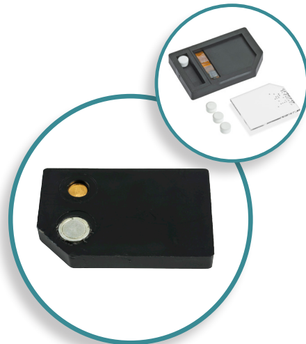
Détecteur CR39, son boîtier convertisseur et les pastilles d'alanine et d'or.
