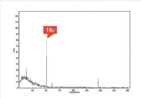
> Exemple de détection d'un pic de Fluor-18 à 511 keV sur le spectre d'une mesure anthroporadiométrique en géométrie corps entier.
